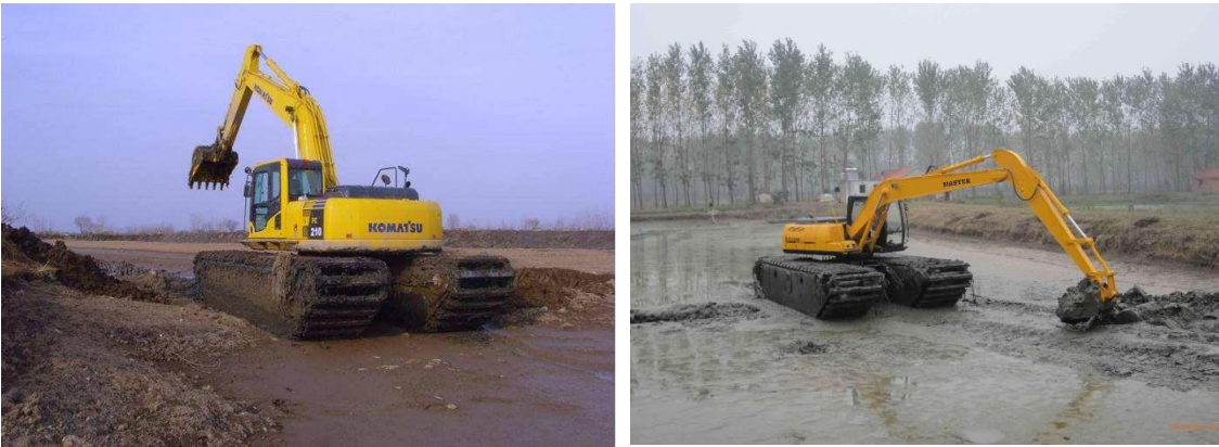
图 5.2-2 两栖式挖掘机池塘底泥清挖示意图
