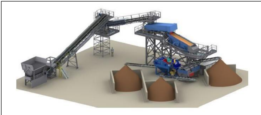
图 4.1-7 异位土壤淋洗修复示意图
