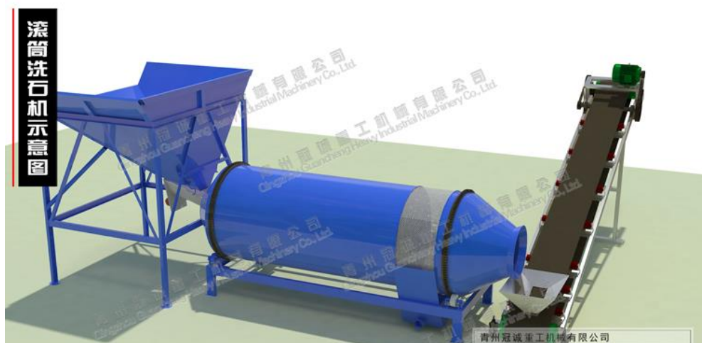
图 5.3-2 滚筒式建筑垃圾清洗机
