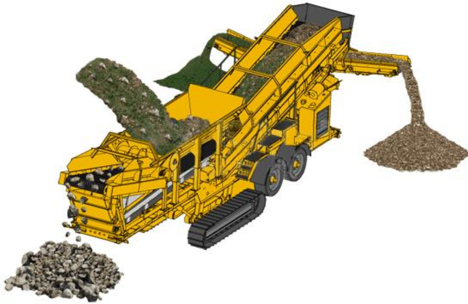
图 5.3-1 建筑垃圾破碎分选效果图
