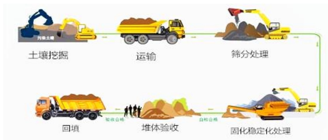
图 4.1-1 原位固化/稳定化和异位固化/稳定化土壤修复示意图
