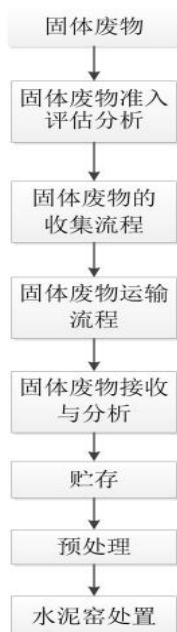
图 2-8 水泥窑综合利用危险废物流程图
