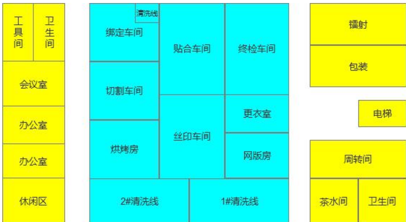
附图三 车间平面布置图 (2F、3F 车间)
