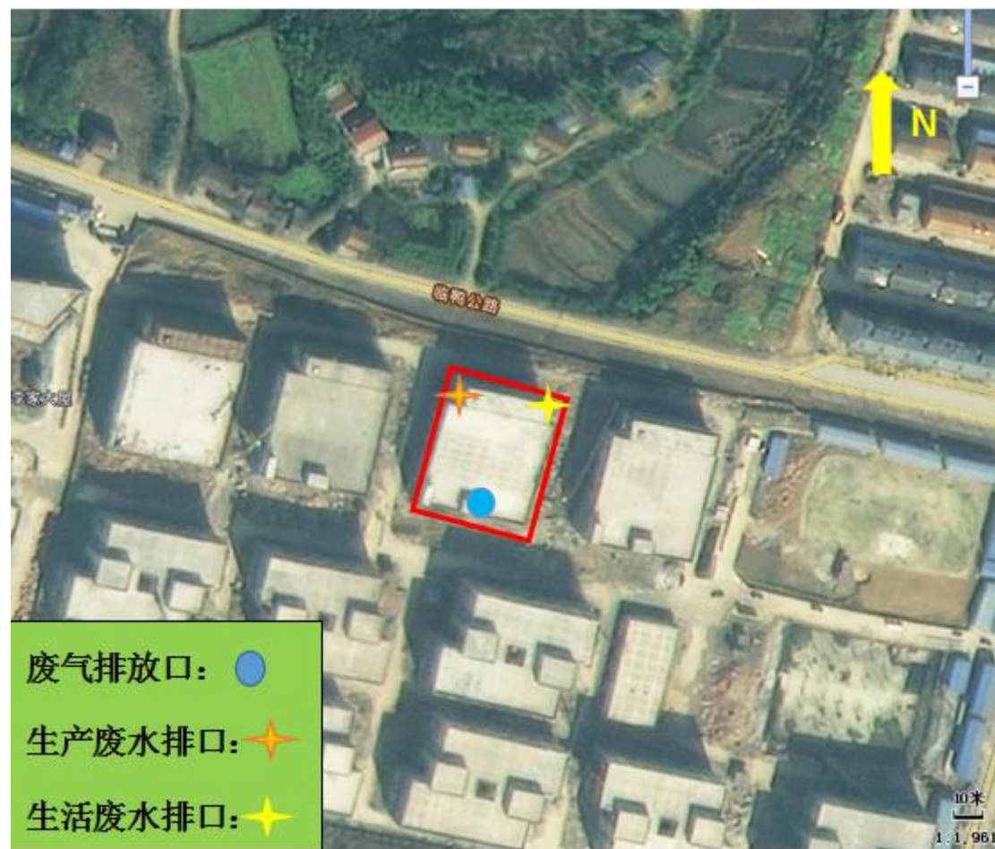
附图三 车间平面布置图（排放口位置）
