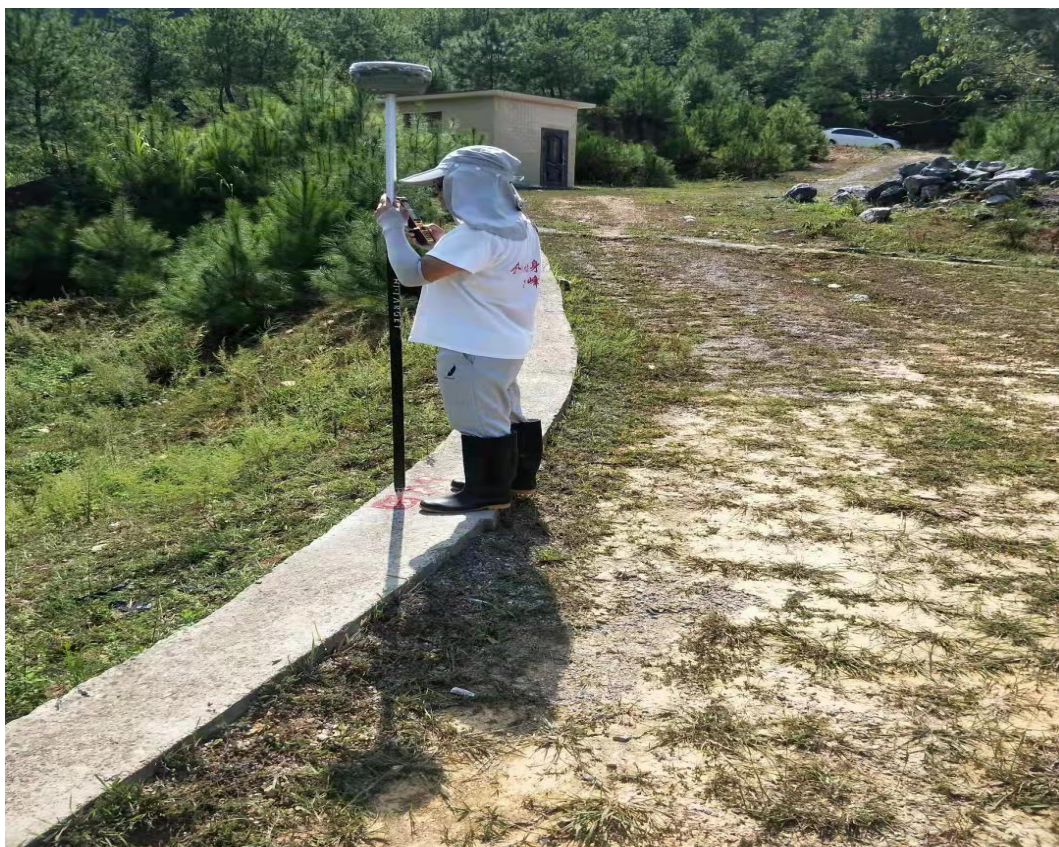
图 3.2-2 水库坝顶高程实测现场（节选）
