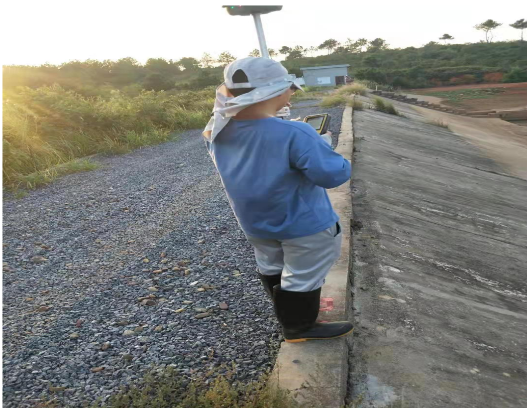
图 3.2-1 水库坝顶高程实测现场（节选）
